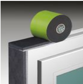
Bild 3: TP653 auf den Rahmen kleben - Seite mit der grauen Stufe nach Innen. An den Ecken überstehen lassen.
