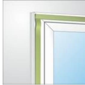
Bild 1: Bandverlegung bei der Fenstermontage
