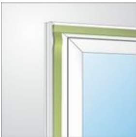
Bild 1: Eckauslegung bei der Fenstermontage
