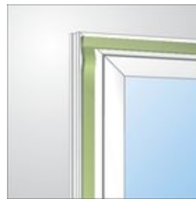
Bild 1: Eckauslegung bei der Fenstermontage
