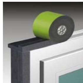
Bild 3: TP321 auf den Rahmen kleben – Seite mit dem Aufdruck nach Innen. An den Ecken das Band überstehen lassen.
