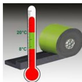
Bild 5: Lagerung und Verarbeitung von TP321 zwischen 8°C und 20°C. Hohe Temperaturen beschleunigen das Aufgehverhalten, tiefe verögern es.
