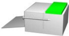
Bild 2: optimaler unterer Fensteranschluss mit dem PR013 Anschlussprofil
